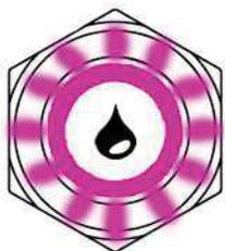
Le bouton-poussoir de l'USE clignote en magenta. L'USE s'arrête ! Le processus de remplissage en eau est trop lent. Réinitialiser l'USE en appuyant sur le bouton pendant 8 secondes et redémarrer-la en appuyant brièvement sur le bouton. Si la LED magenta clignote à nouveau, appeler le service technique.
