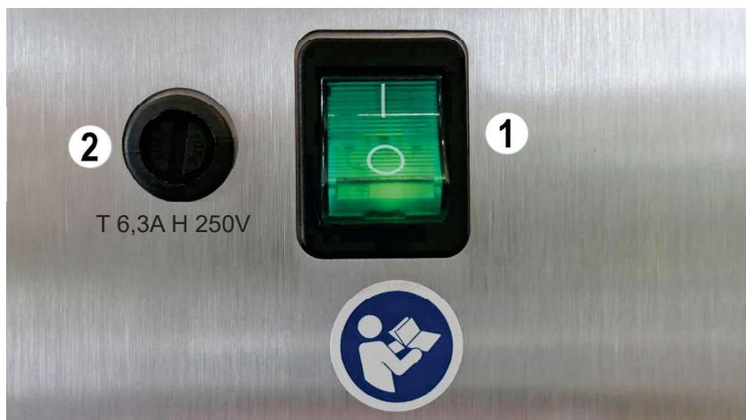
Le poste de traitement est équipé d'un interrupteur principal ① placé sur la base du fauteuil. L'interrupteur principal relie le poste de traitement au secteur. Le poste doit être déconnecté du réseau s'il n'est pas utilisé pendant de longues périodes.
